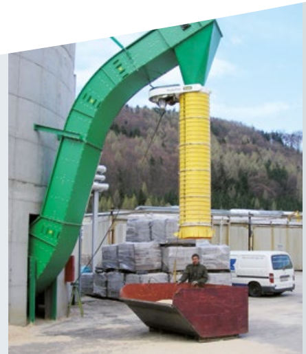
Verladeeinrichtung mit Trogkettenförderer und Verladebalg
