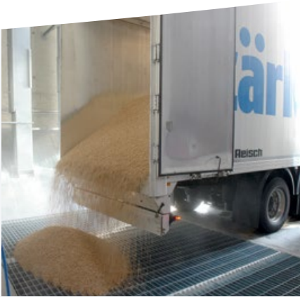
Annahmegossen für LKW- und Bahnentladung
