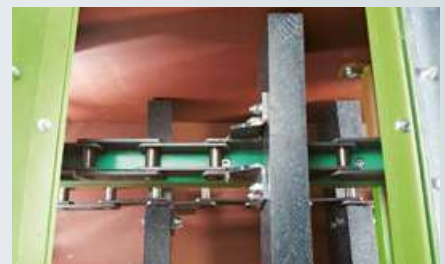
Buchsenförderkette mit aufgeschraubten Kunststoffmitnehmer
