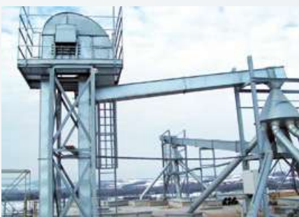
Produktverteilereinheit bestehend aus Gurtbecherwerk, Trogkettenförderer und Drehrohrverteiler
