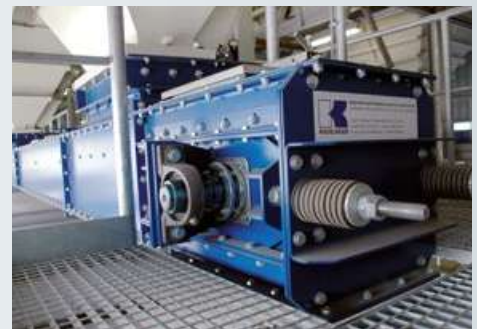
Spannstation eines Trogkettenförderers für eine Filterentstaubungsanlage
