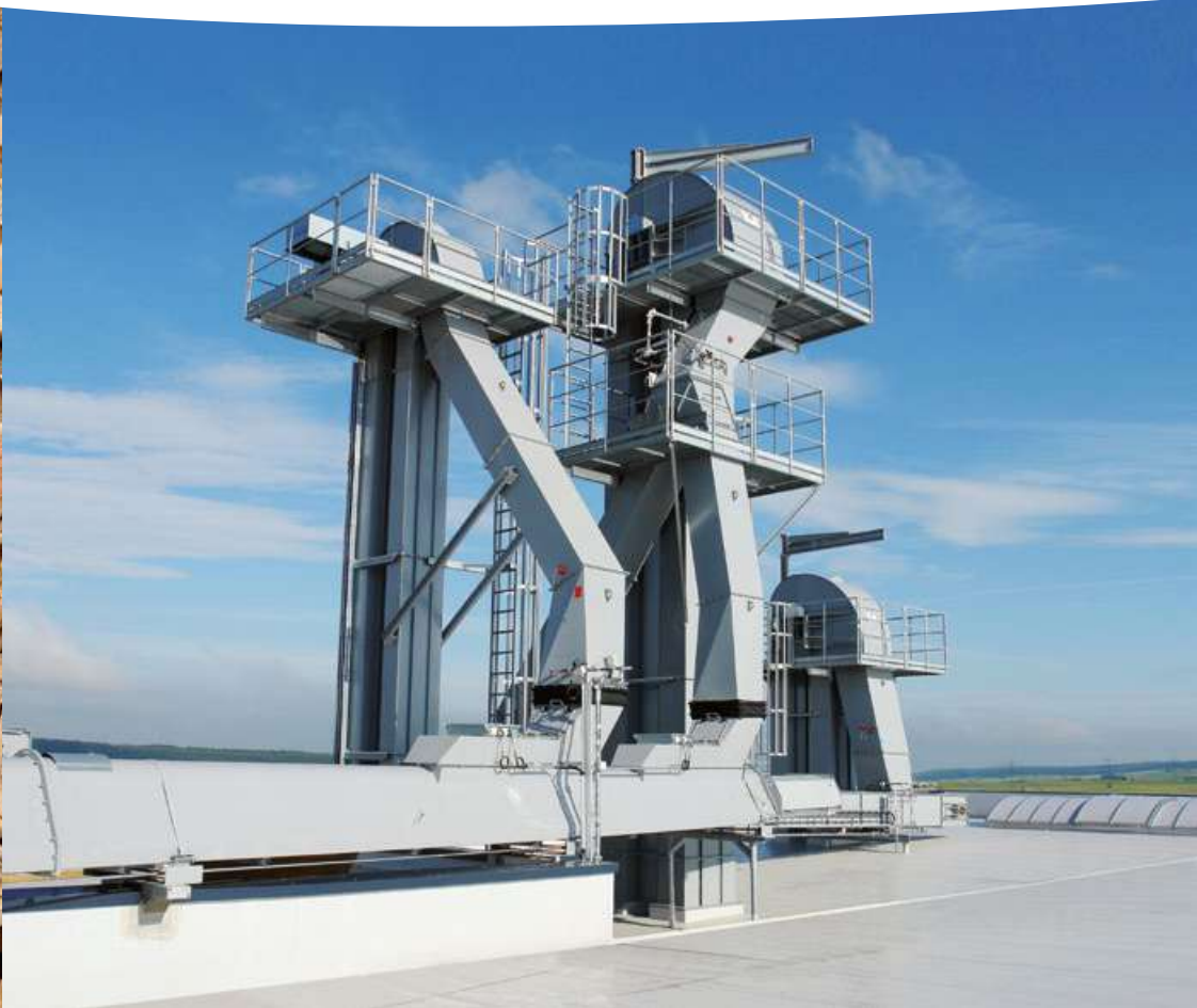
Anlagen von 15–600 m 3 /h mit Becherwerken / Kettenförderern / Förderschnecken
