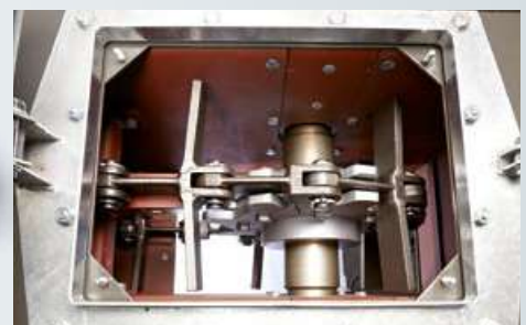
Antriebsstern eines Trogkettenförderers mit Gabellaschenkette
