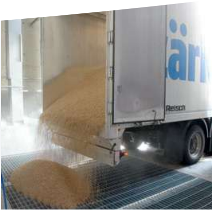
Annahmegossen für LKW- und Bahnentladung
