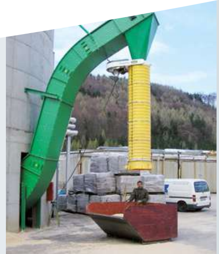
Verladeeinrichtung mit Trogkettenförderer und Verladebalg
