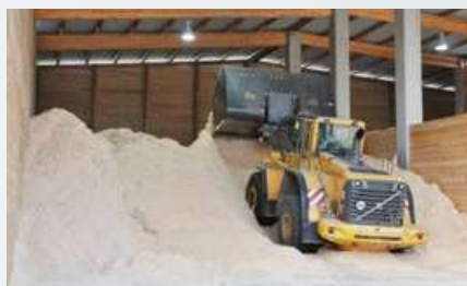
Rohstoff-Übernahme mit hydraulischem Austragboden
